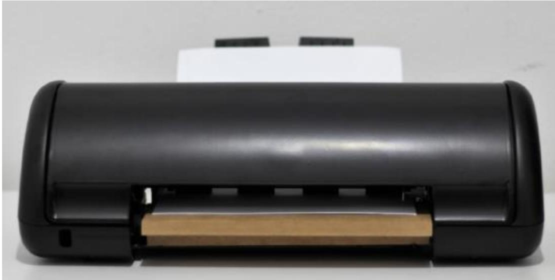
La impresora finalizada en su paso de montaje se muestra en la Figura. Para preservar la seguridad del usuario deficiente visual, teniendo en cuenta que la impresora posee una aguja que puede causar lesiones, se optó por no dejar la estructura mecánica de la impresora muestra realizando el cierre de la misma. Además, el uso de la cubierta de plástico protectora redujo el ruido y la dejó estéticamente más bonita.
